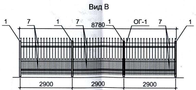
1. Сварку элементов элементов выполнять в соответствии с требованиями ГОСТ 5264-80\* и ГОСТ 14098-91. Сварку производить электродами Э42 ГОСТ 9467-75\*. Катет сварного шва принять не более толщины свариваемого металла.
