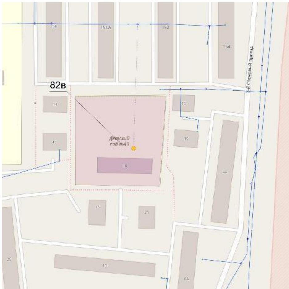
Рисунок 96. Схемы трасс сетей ВС для подключения объектов капитального строительства перспективной застройки в городе Кострома
