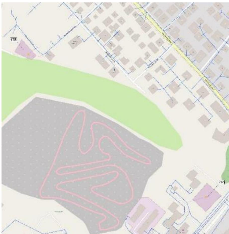
Рисунок 93. Схемы трасс сетей ВС для подключения объектов капитального строительства перспективной застройки в городе Кострома
