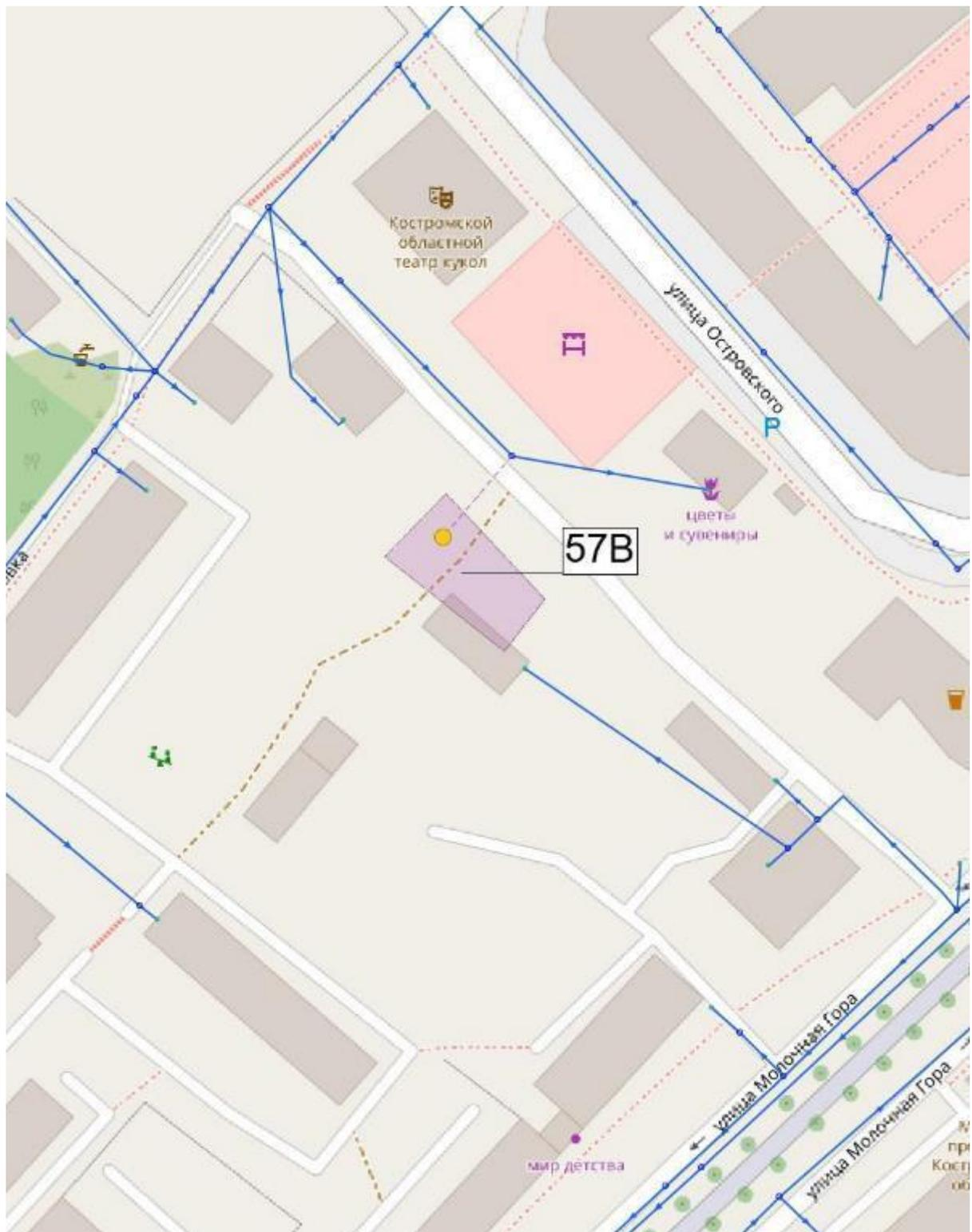
Рисунок 76. Схемы трасс сетей ВС для подключения объектов капитального строительства перспективной застройки в городе Кострома
