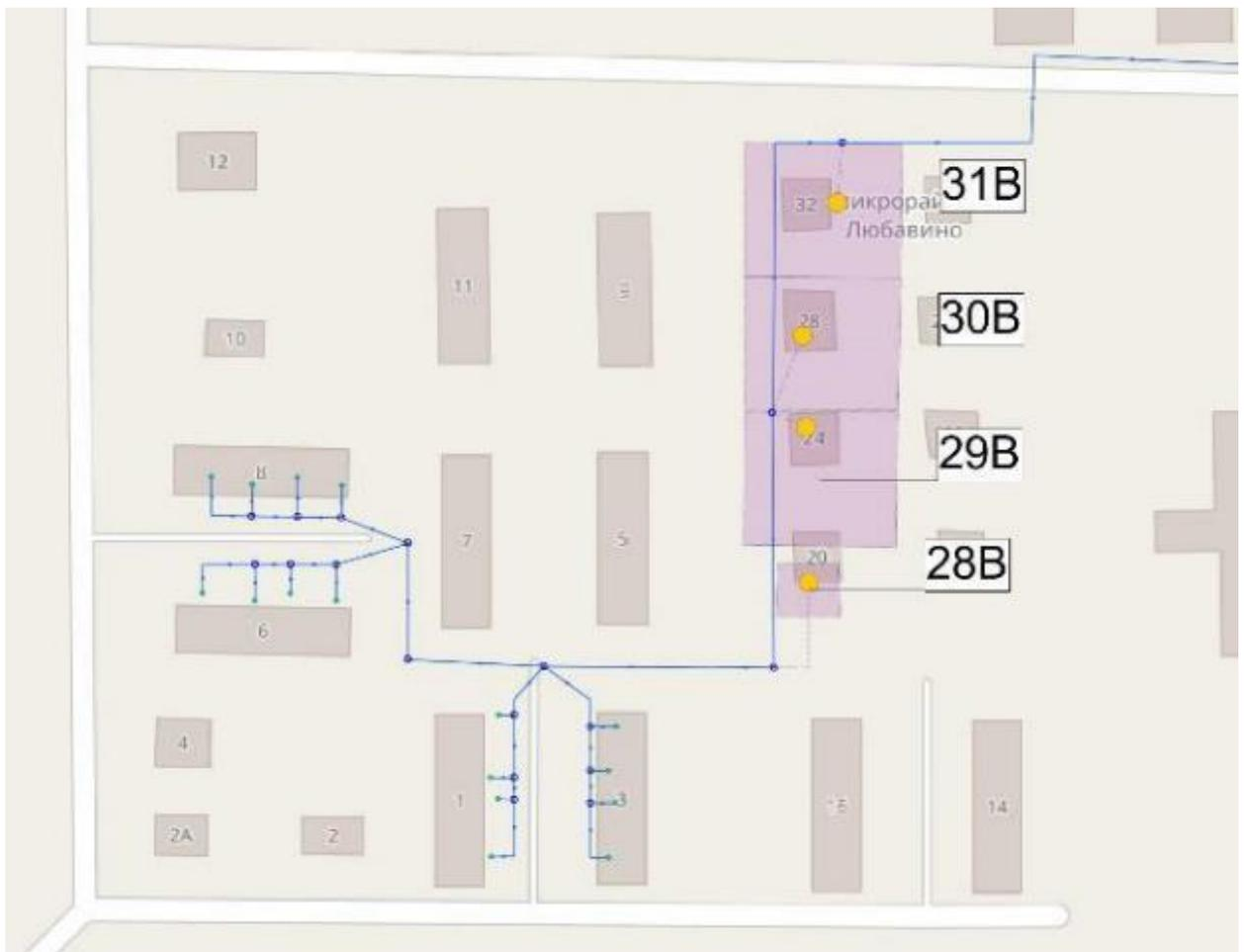
Рисунок 85. Схемы трасс сетей ВС для подключения объектов капитального строительства перспективной застройки в городе Кострома
