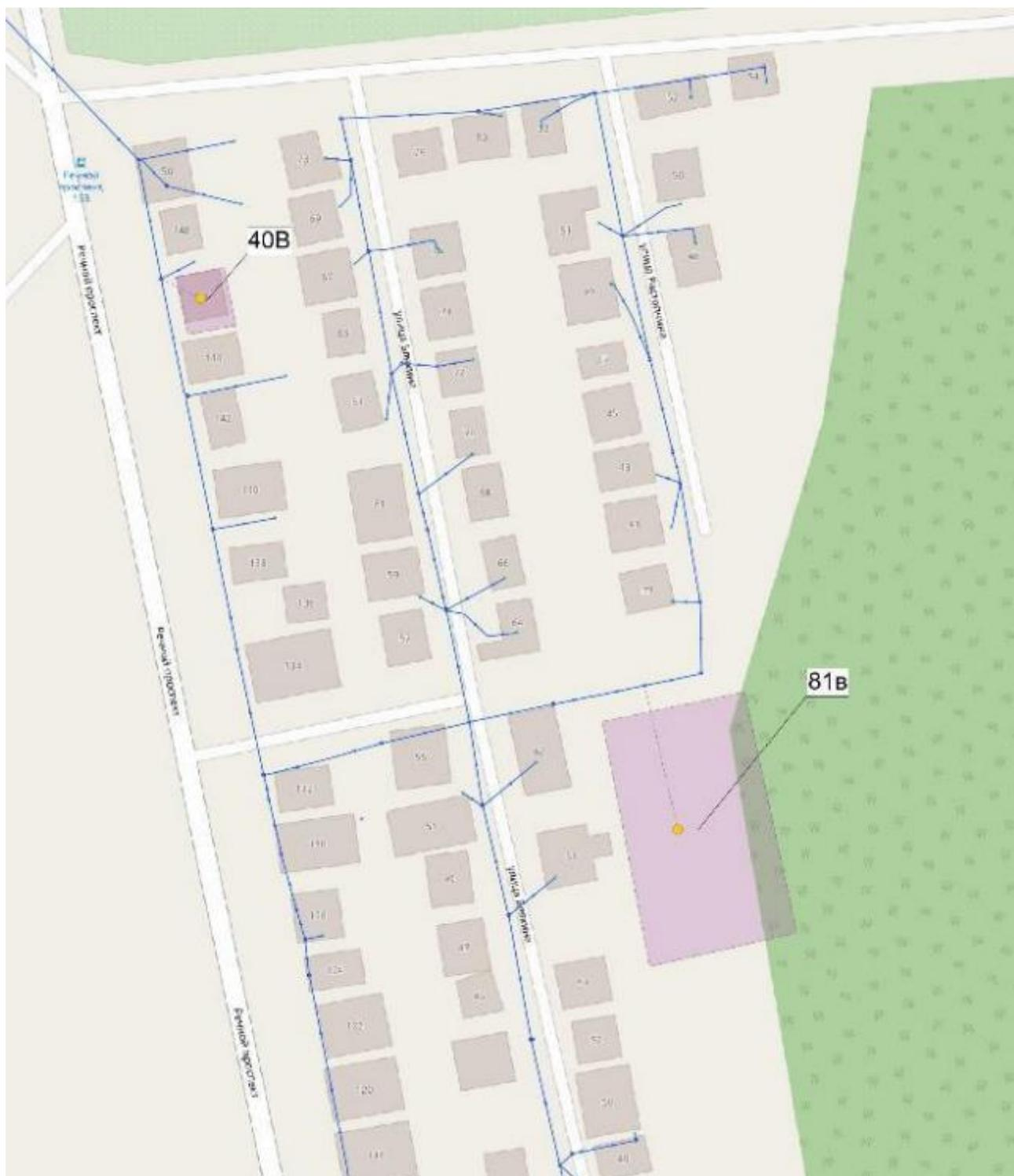
Рисунок 83. Схемы трасс сетей ВС для подключения объектов капитального строительства перспективной застройки в городе Кострома
