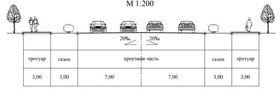
Типовой поперечный профиль Рабочего проспекта
