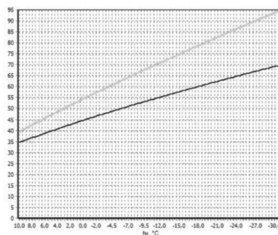
При существующей нагрузке системы теплоснабжения и пропускной способности тепловых сетей данный температурный график способен обеспечить поддержание комфортной температуры и влажности воздуха в отапливаемых помещениях.
