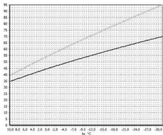
При существующей нагрузке системы теплоснабжения и пропускной способности тепловых сетей данный температурный график способен обеспечить поддержание комфортной температуры и влажности воздуха в отапливаемых помещениях.
