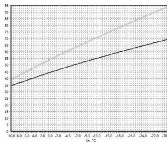
При существующей загрузке системы теплоснабжения и пропускной способности тепловых сетей данный температурный график способен обеспечить поддержание комфортной температуры и влажности воздуха в отапливаемых помещениях.
