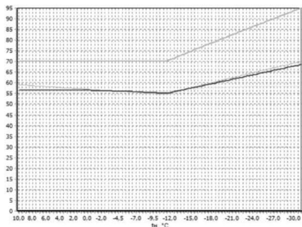
При существующей нагрузке системы теплоснабжения и пропускной способности тепловых сетей данный температурный график способен обеспечить поддержание комфортной температуры и влажности воздуха в отапливаемых помещениях.
